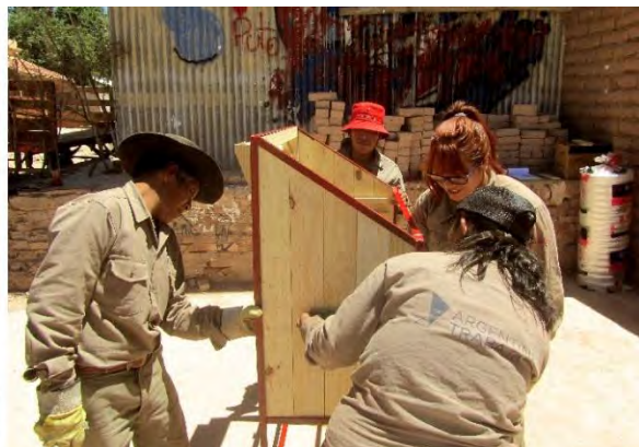
Imágenes del taller práctico: montando las partes del deshidratador.
