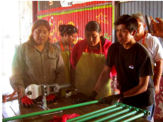
Imágenes del taller práctico: prácticas en el armado de cañerías termo fusionadas para el montaje del circuito de agua.
