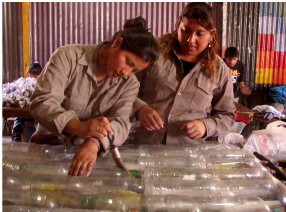
Imágenes del taller práctico: construcción del colector solar con botellas plásticas recicladas.
