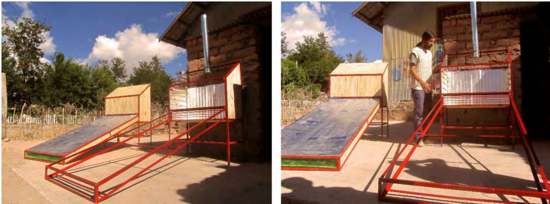
Imágenes de los dos deshidratadores próximos a terminarse, con variaciones en su diseño con el objetivo de realizar mediciones comparativas en su funcionamiento.
