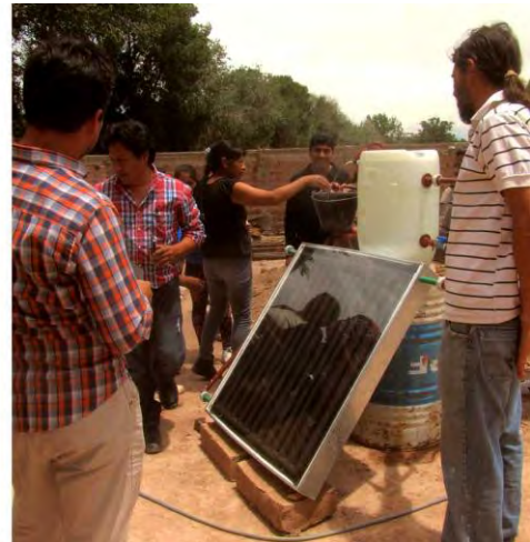
Imágenes del taller práctico: construcción del colector solar con sistema de cañerías termo-fusionadas.
