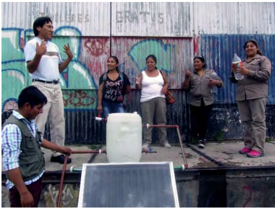
Pruebas de funcionamiento y armado final del colector.
