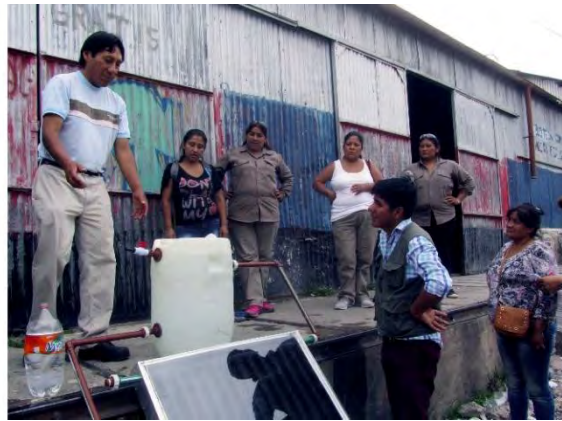
Pruebas de funcionamiento y armado final del colector.
