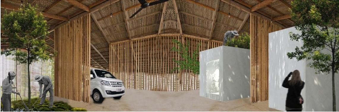
*Esquema de una propuesta apropiada de Infraestructuras Productivas Bioclimáticas: sobretecho térmico, fachadas ventiladas, funciones separadas, vegetaciones internas, etc.*
