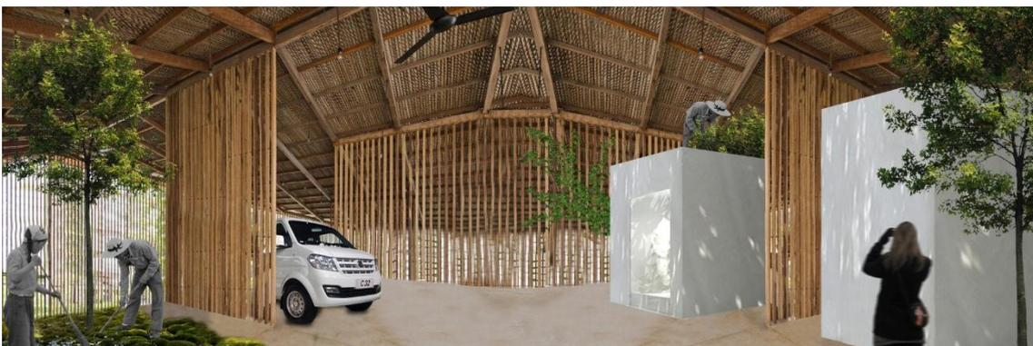
*Esquemas de adaptación de Salas de Extracción de Miel modelo INTA (Schneider y Haag, 2013), a un diseño bioclimático apropiado a las condiciones del Chaco. Se le incorporan: sobretecho térmico, fachadas ventiladas, funciones separadas, vegetaciones internas, etc. Toda la intervención favorece la ventilación cruzada del conjunto, logrando un confort térmico pasivo de eficiencia (autor: XhARA).*
