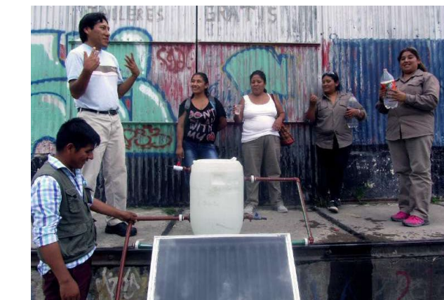
Calentador solar de agua con sistema de cañerías
