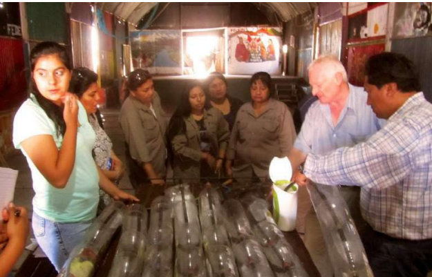
Calentador solar de agua con botellas de plástico
