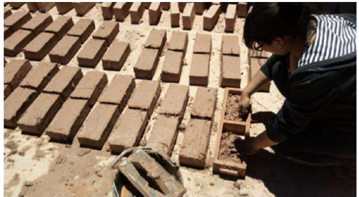
Fabricación de adobes de distintas dimensiones (25 x 40 x 12cm y 12 x 26 x 6 cm).
