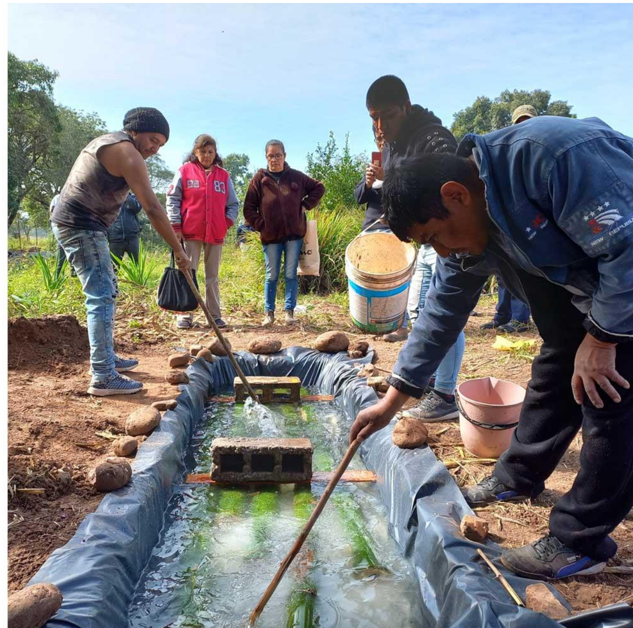
Perforación de la caña y curado por inmersión en solución de agua, sales de borato y ácido bórico.
