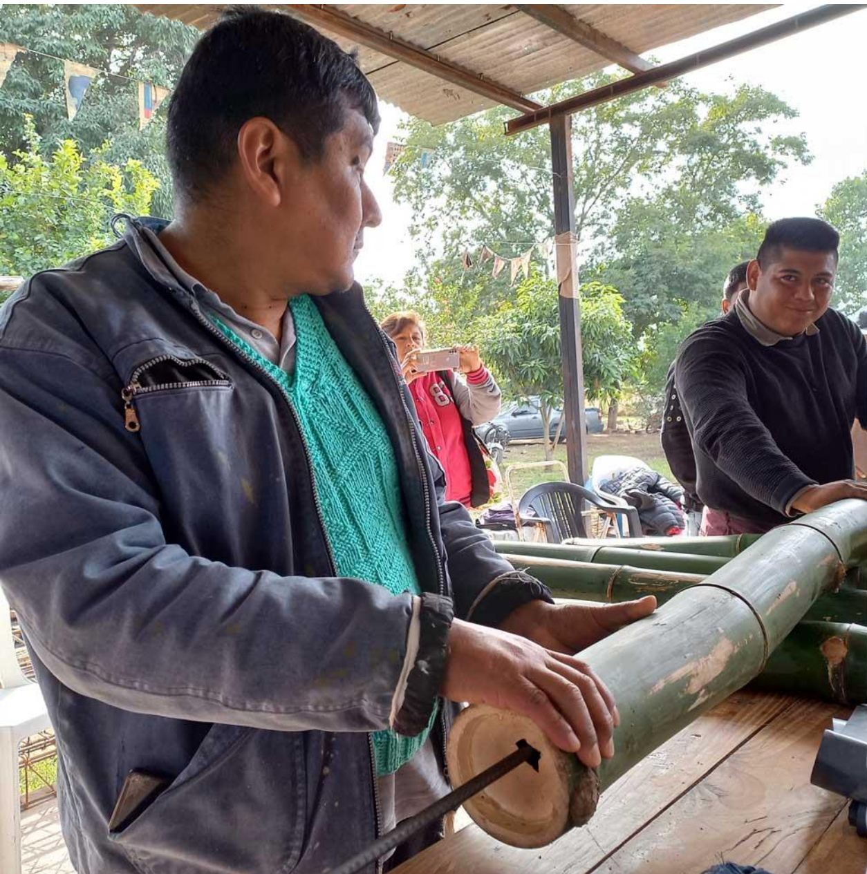
Perforación de la caña y curado por inmersión en solución de agua, sales de borato y ácido bórico.
