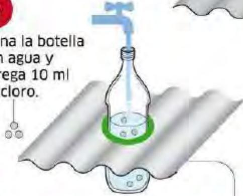
**4** La botella captura los rayos solares y los amplifica como un prisma, alumbrando la zona oscura de la casa como si fuera un foco eléctrico encendido. No interesa que haya un día soleado para ver sus efectos.
